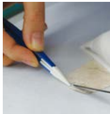
Methodenentwicklung im Verbund: Anwendung eines wiederbefeuchtbaren Nanocellulose-Films zur lokalen Stabilisierung einer Handschrift des Bundesarchivs
