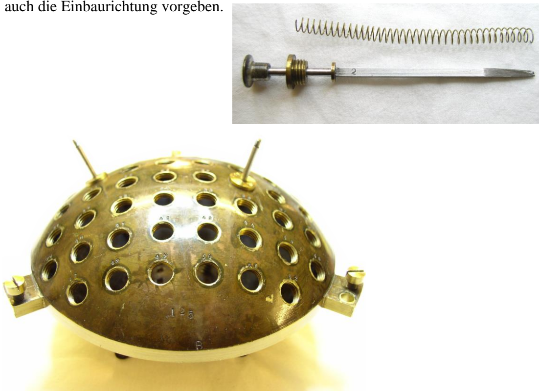
Abb. 15: Hohle Schreibkugel und Typenstange 8
