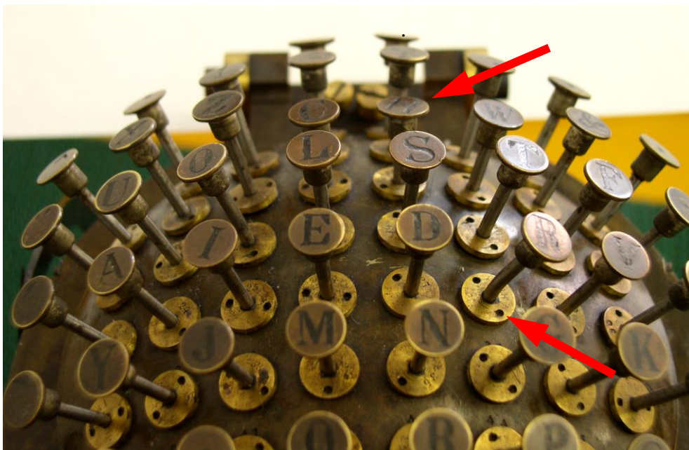
Abb. 14: Typenstangen - verdreht, verklemmt, verbogen, verschmutzt.
