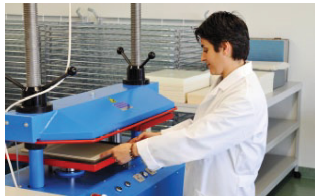
Restaurierungswerkstatt für brandgeschädigtes Schriftgut Weimar/Legefeld: Hydraulische Presse
